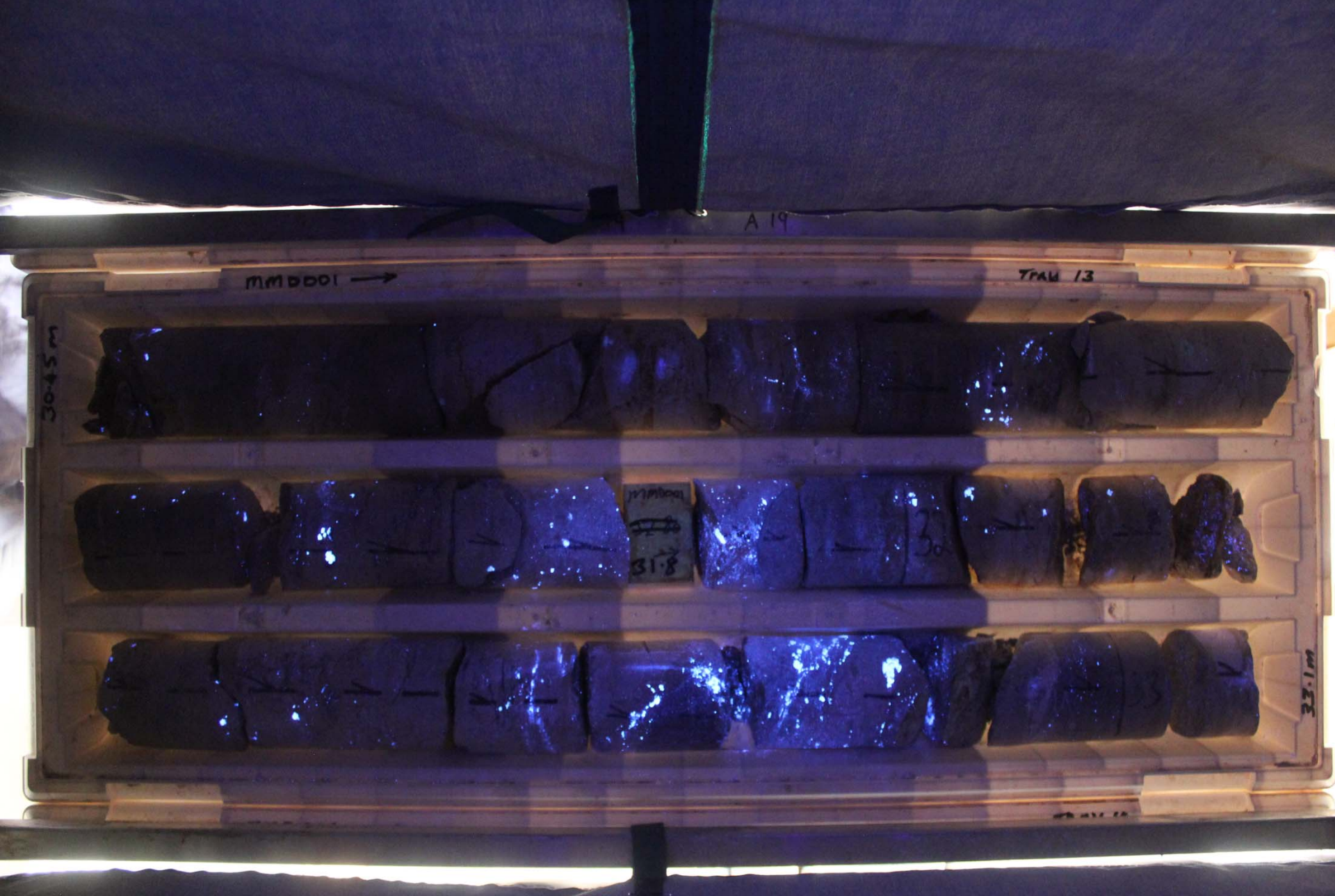
图：Mulgine Hill矿床的钻孔岩心显示粗粒白钨矿（紫外线照片）
